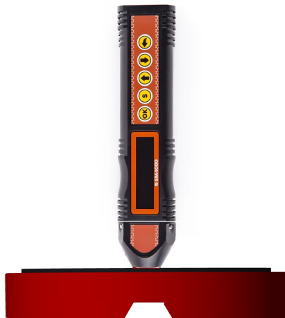
Расположение прибора при калибровке “нуля”
