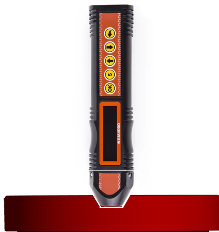
Расположение прибора при калибровке “Толщина”
