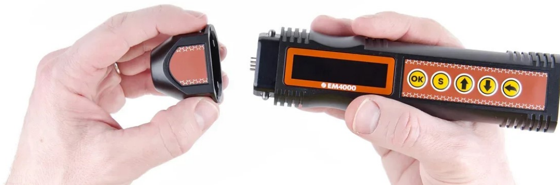
Отсоединение преобразователя EMT40001
